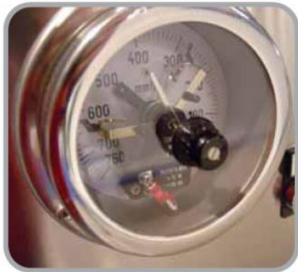
Vuotometro. Controllo automatico del vuoto con range prefissabile dall'operatore \ Vacuum-meter. Automatic control of vacuum degree within a preset range
